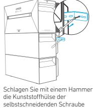
M5×60 in das Loch. Befestigen Sie dann mit einem Kreuzschlitzschraubendreher die selbstschneidende Schraube M5×60 am L-förmigen Wandmontagebeschlag
